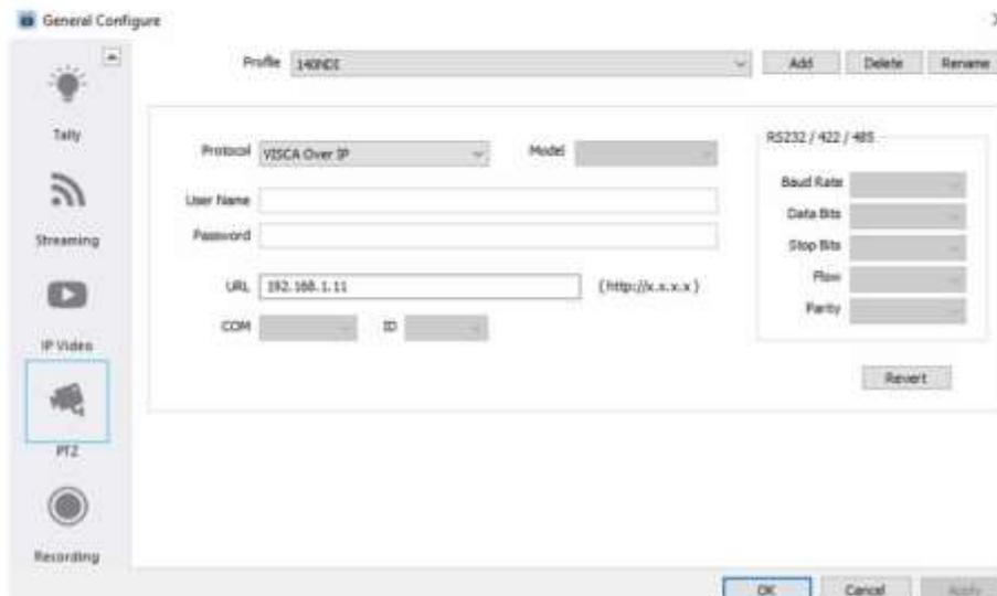
TVS-3000은(는) CGI, VISCA, ONVIF, Pelco D 및 Pelco P 제어 프로토콜을 통해 네트워크로 연결된 PTZ 카메라 작동을 지원합니다. 또한 RS-232, RS-422 및 RS-485 인터페이스를 통해 PTZ 카메라 작동을 지원합니다. 새 설정을 추가한 다음 목록에 PTZ 카메라 정보를 입력하세요.
