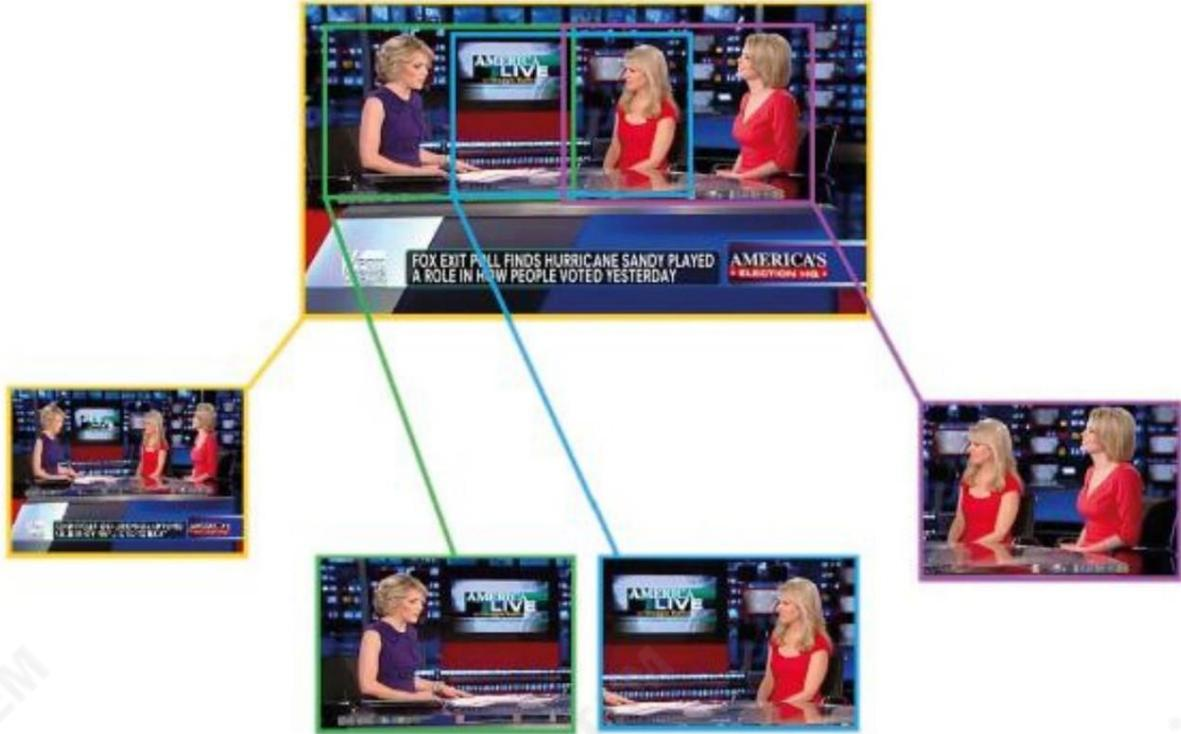
각 UHD 소스 신호에 대해 4개의 출력 창(프레임 1/2/3/4)을 정의할 수 있습니다. 프레임 1 창의 해상도는 최대 3860x2160이고 프레임 2, 3 및 4는 최대 1920x1080 픽셀의 해상도를 지원합니다. 모든 프레임 창에 애니메이션을 적용할 수 있습니다. 애니메이션은 프레임 창의 시작 및 끝 위치와 모션 모드(싱글, 루프, 핑퐁)를 정의하여 생성됩니다. 가상 디지털 줌 기능이 있는 프레임 창은 애니메이션되는 동안 크기를 변경할 수 있습니다.
