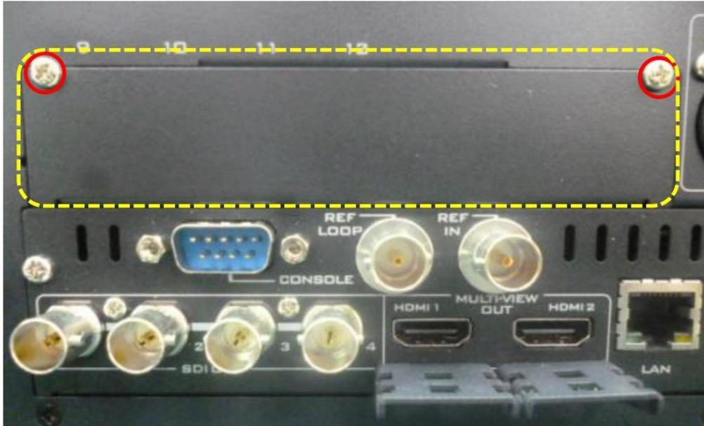
G0911D300413 Nyloc 작은 나사 / ISO 둥근 머리  $\phi 3.0 \times 4\text{m/m}$  니켈 도금\*2 G09220639022 VIDIN 블록 패널 SECC 1.0 VP-639 도장 질은 청색 가는 직조 2판 성형\*1
