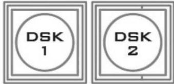
HS-2850 제어판/키보드의 오른쪽 상단을 보면 4개의 DSK 키가 있습니다. 이들은 프로그램 및 사전 설정으로 레이블이 지정됩니다. 상위 DSK1 및 DSK2 키는 프로그램 출력에서 다운 스트림 키를 활성화하는 것과 관련됩니다. 하단 DSK1 및 DSK2 키는 멀티뷰 또는 미리보기 출력에서 다운스트림 키를 활성화하는 것과 관련됩니다.
