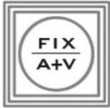
새 설정이 저장되면 FIX/A+V 버튼 (WIPE 영역)을 눌러 오디오 고정 모드와 오디오 팔로우 비디오 모드 사이를 전환합니다. HDMI 멀티뷰의 상태 영역을 확인 하여 AUDIO FIXED 상태가 선택되었는지 확인하세요. 상태 영역은 HDMI 멀티뷰 모니터의 미리보기 이미지 바로 아래 또는 근처에 있습니다. 버튼이 빨간색으로 백라이트됩니다.
